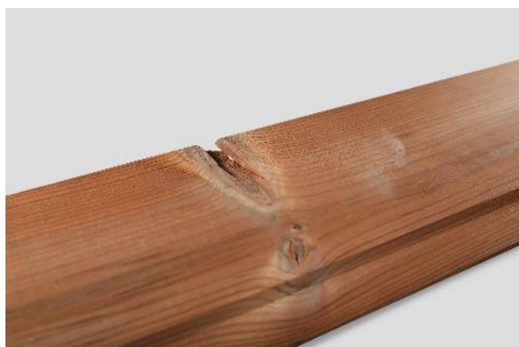
Duże pęknięcie sęka.
